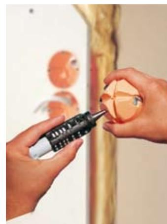
Для точных отверстий и герметичного ввода труб и проводов была разработана универсальная фреза.
