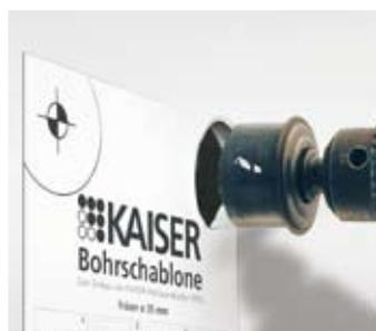
Приклейте прилагаемый шаблон для сверления к стене, вскройте четыре угла фрезой, после этого прорежьте отверстие в стене ножовкой или ротационной машиной.
