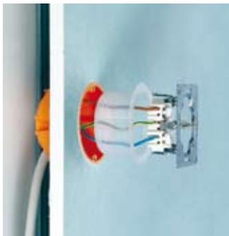
Контур герметизации поверхности стены, а также герметичное обтекание отдельных жил кабеля предотвращают образование нежелательных воздушных потоков. После завершения монтажа устройства достигается требуемая герметичность.
